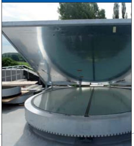
Abb. 5: Heliostat (Ø 3 m) mit nachführbarem Spiegel
